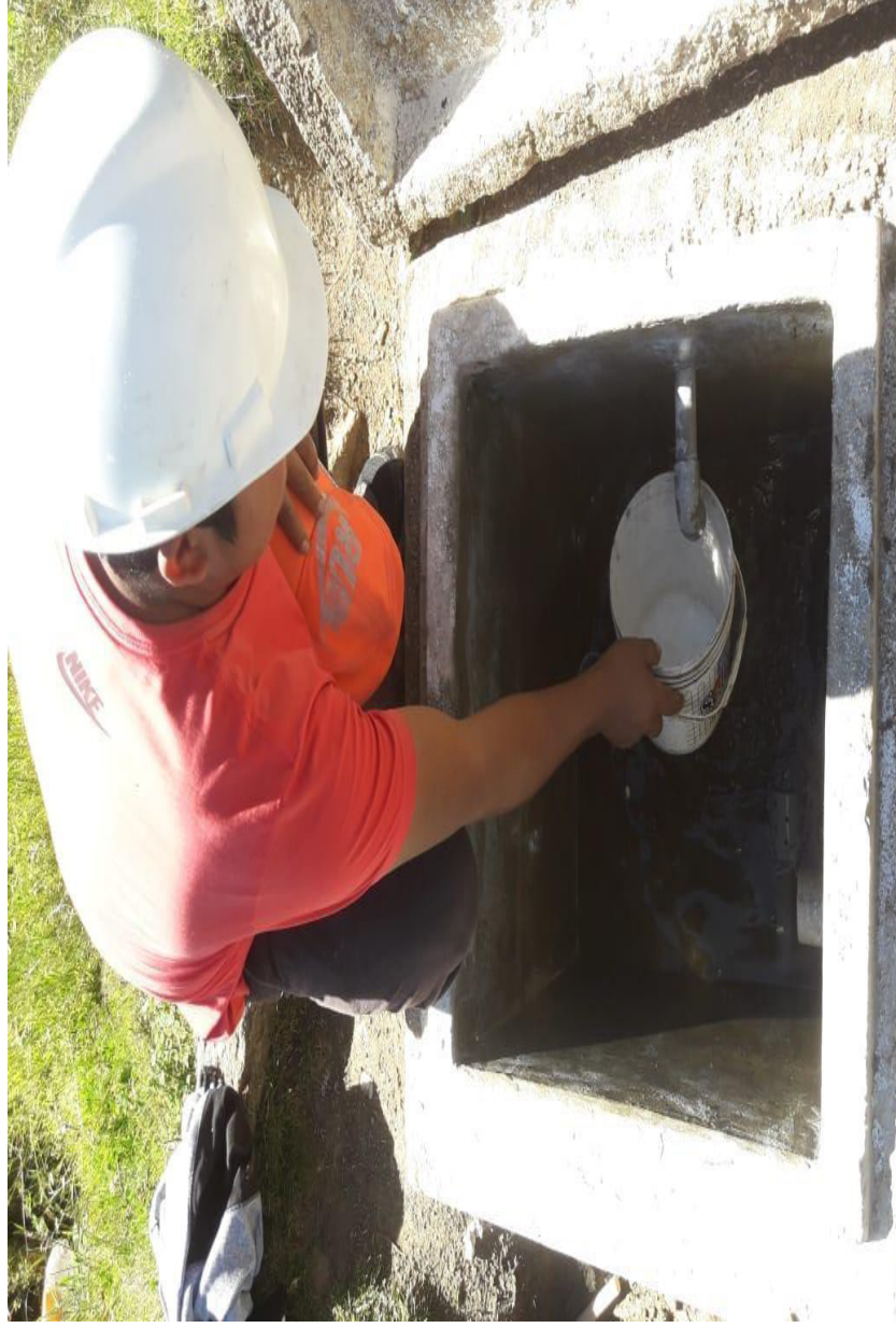
Figura 20. Vista del aforo de la fuente en un balde (8lt) para el método volumétrico.
