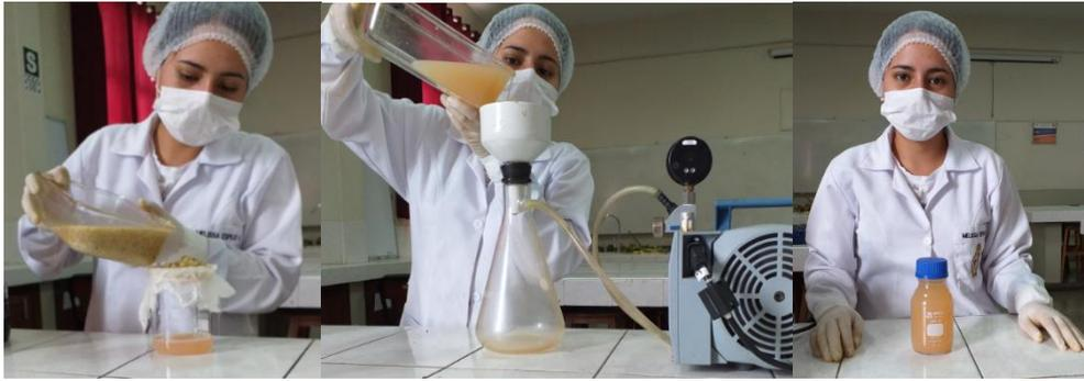
**Fig. 11 Filtrado, secado al vacío y almacenamiento del extracto acuoso de la mezcla de cáscara y semilla del fruto *M. dubia***
