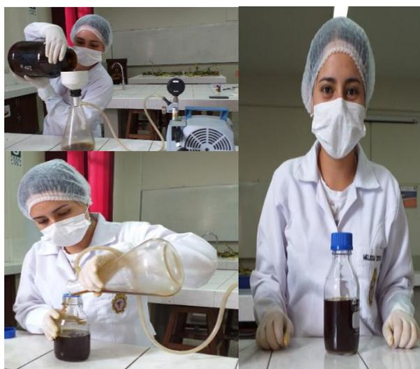
**Fig. 10 Filtrado, secado al vacío y almacenamiento del extracto hidroetanólico de la semilla del fruto *M. dubia***
