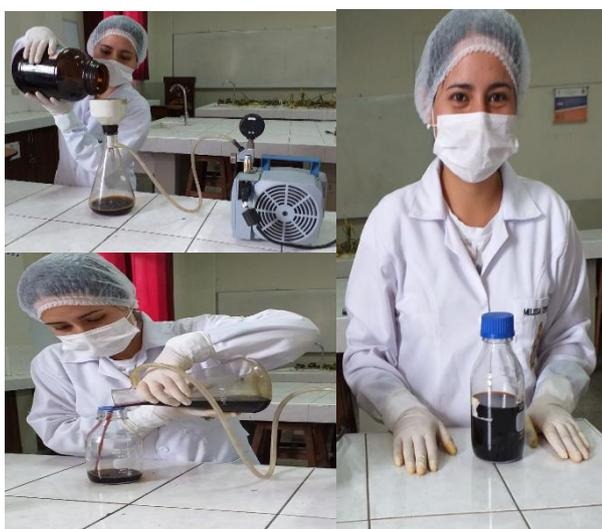
**Fig. 9 Filtrado, secado al vacío y almacenamiento del extracto hidroetanólico de la cáscara del fruto *M. dubia***
