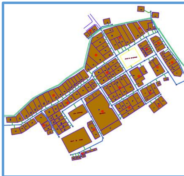
Figura 33. Red mallada de agua potable
