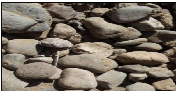
Figura 5: Material de relleno - Canto rodado Fuente: Bolívar (16)
