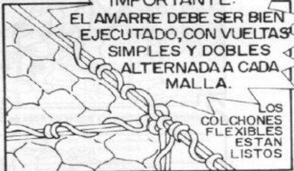
9 Una vez llenadas varias unidades coloque las tapas, que son suministradas separadamente, amarrándolas a todos los paneles, diafragmas y tirantes de tal forma queden bien estirados.
