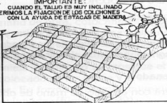
7 Posicione los colchones Flexibles en el local definido en el diseño y amárrelos uno a otro a lo largo de todas las paredes en contacto.
