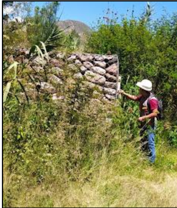
Figura 21: Evaluación de volteo de muro de gavión
