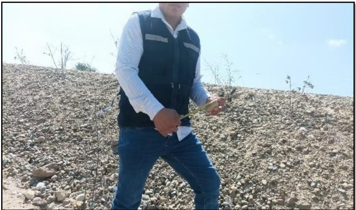
Figura 18: grava, granulometría de 2 pulgadas.
