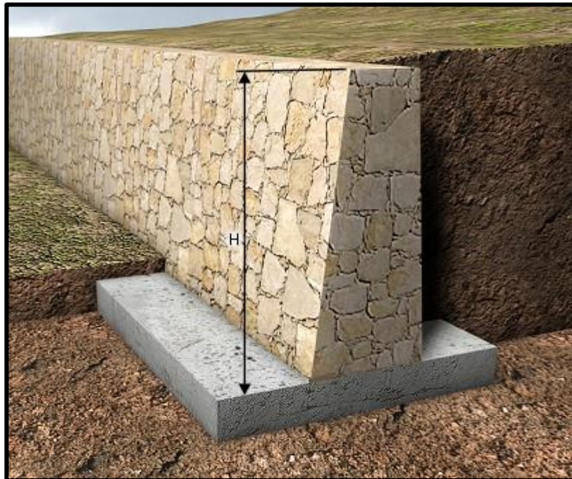
Figura 10 Muro de Mampostería Fuente: http://www.generadordeprecios.info/
