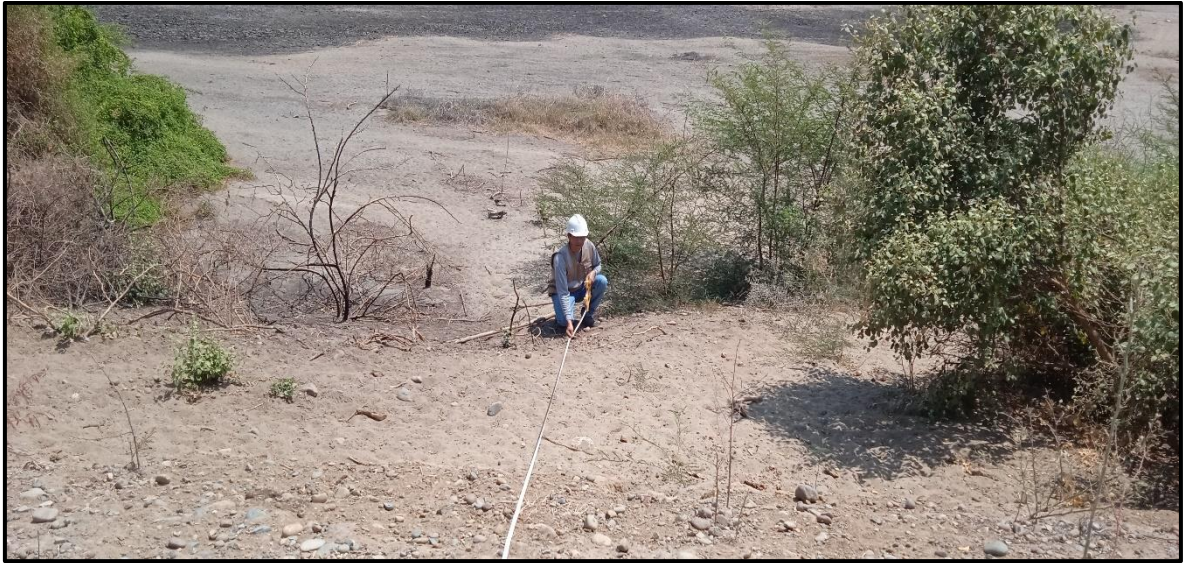
FOTOGRAFIA 08: Medición de la longitud (hipotenusa) del talud (tomada el 13/04/2024).
