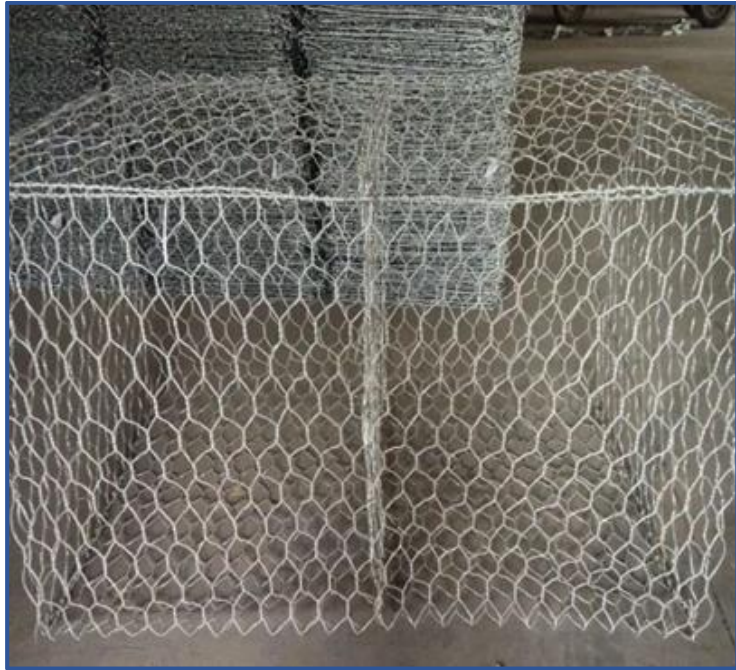
Figura 11: Mallas hexagonales. Obtenido del libro Vásquez et al (14).
