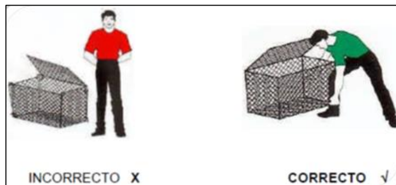
Figura 3: Armado de los gaviones
