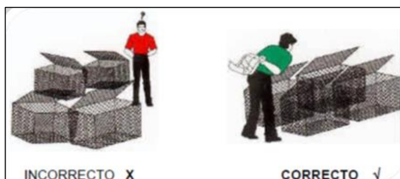
Figura 4: Modular los gaviones
