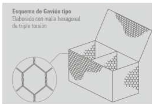
Figura 3. Esquema de Gavión tipo caja. Fuente:(A Bianchini, 2017).
