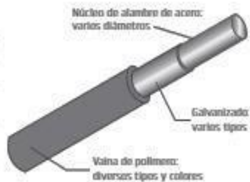
Fig. 9.10 Composición del alambre usado en productos de doble torsión
