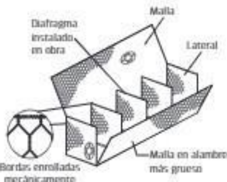
Fig. 9.19 Diseño esquemático del gavión CajaFuerte ®
