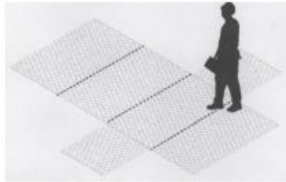
Figura 12. Extensión y dobleces de la malla. Fuente: (ACEROS METALES Y MALLAS LTDA, 2016)
