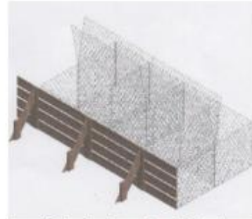
Figura 13. Encofrador posicionado junto a los gaviones. Fuente: (ACEROS METALES Y MALLAS LTDA, 2016)
