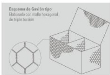
Figura 3. Esquema de Gavión tipo caja. Fuente:(A Bianchini, 2017).
