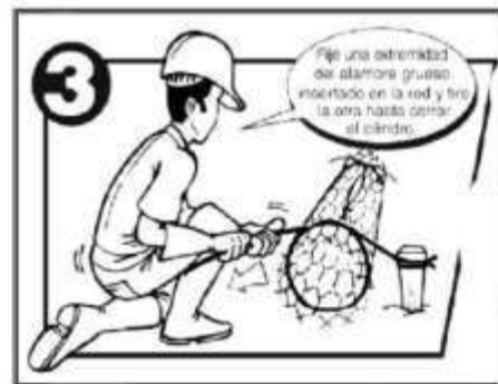
Figura 16. Amarre de los extremos. Fuente: (Morassutti F, 2013)
