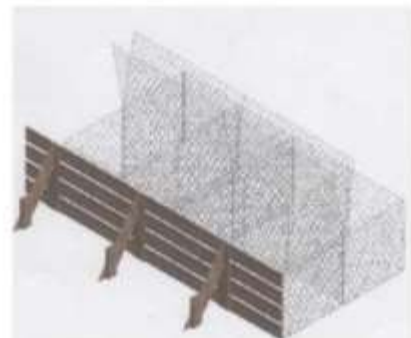
Figura 13. Encofrador posicionado junto a los gaviones. Fuente: (ACEROS METALES Y MALLAS LTDA, 2016)
