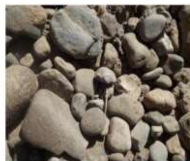
Figura 11. Rocas para el llenado de gaviones. Fuente: https://pixabay.com/es/photos/piedras-ripio-gaviones-de-piedra-1323243/
