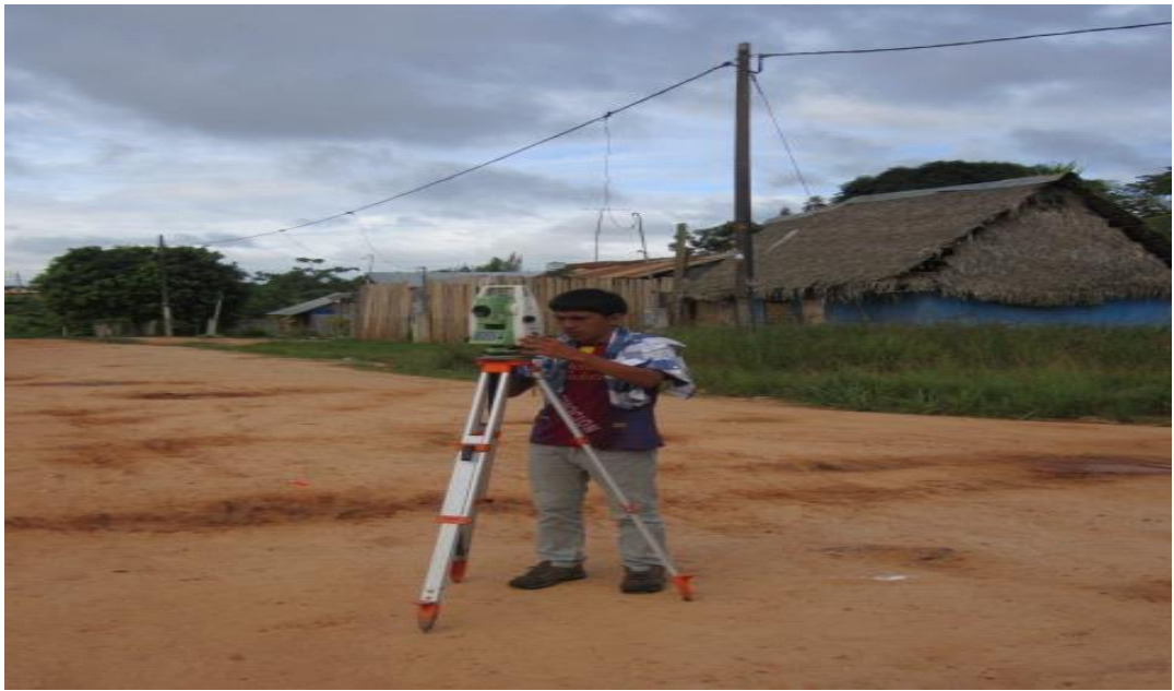
FOTOGRAFIA N°1: Se Observa al Operador Visando Puntos con la Estación Total; en el cruce de la AV. Belizario Panduro con Jr.Vicente Maynas
