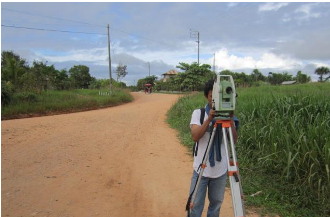
FOTOGRAFIA N°4: Se observa al operador visando puntos con la Estación Total en la Av. BELIZARIO PANDURO
