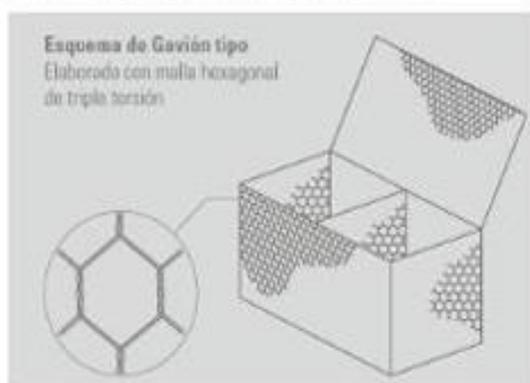
Figura 3. Esquema de Gavión tipo caja. Fuente:(A Bianchini, 2017).
