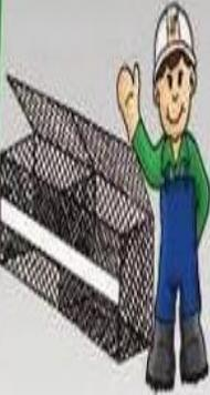
Usar tablas para disminuir la posibilidad de deformación de las caras exteriores del gavión durante el llenado.
