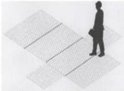
Figura 12. Extensión y dobleces de la malla. Fuente: (ACEROS METALES Y MALLAS LTDA, 2016)
