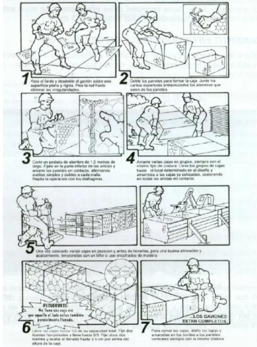
**Figura 5.** Procedimiento de llenado de Gavión tipo caja
