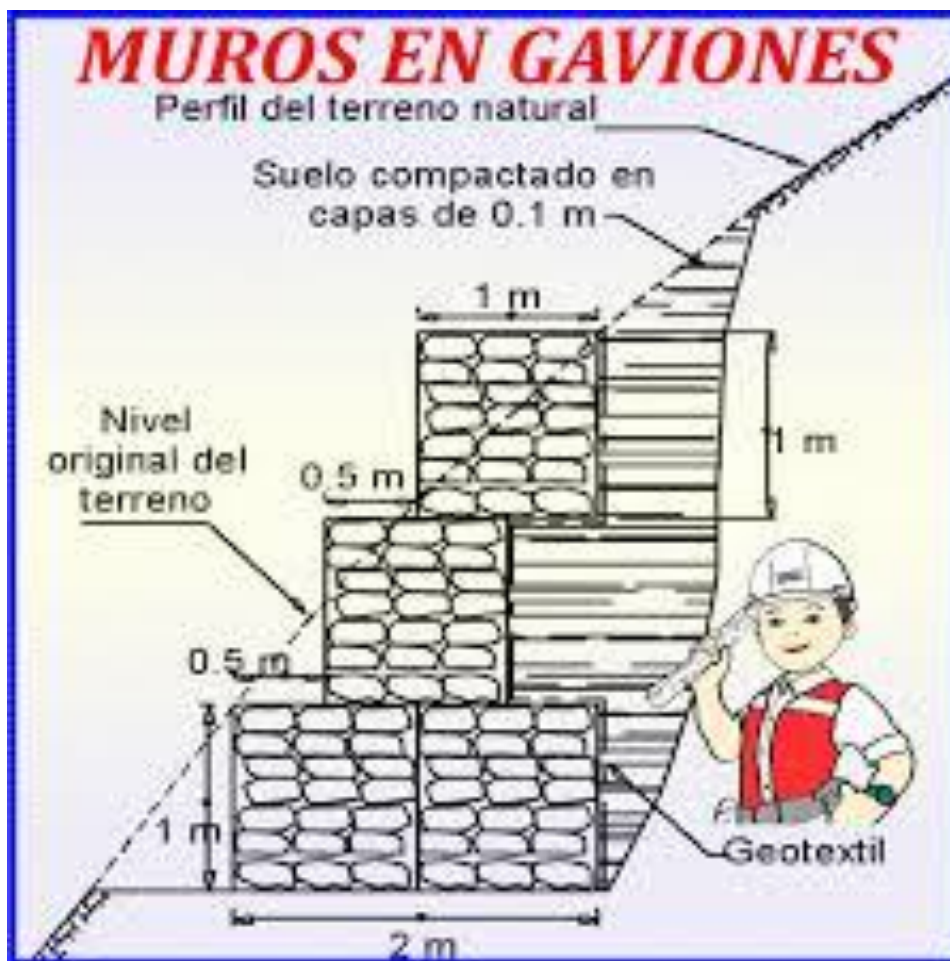
Figura 2: Muros de gaviones para evaluar
