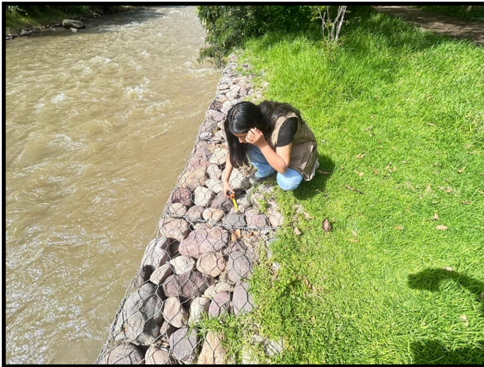
Figura 34. Levantamientos del tamaño de la roca, progrs. 9+100 y 9+200
