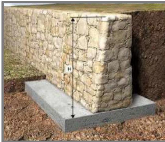
Figura 22: Muros de contención.
