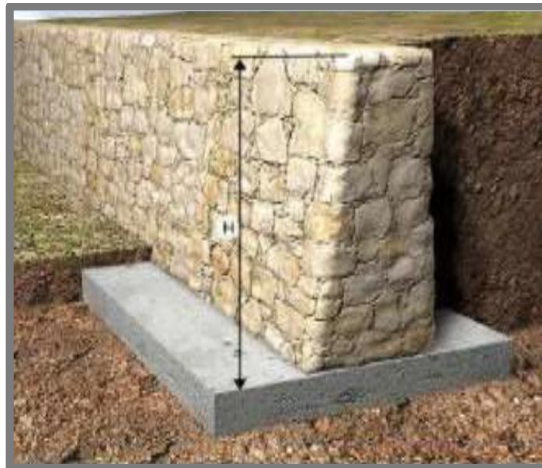
Figura 22: Muros de contención.
