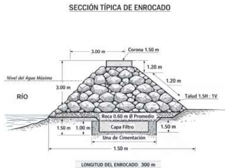
Figura 11: Sección típica del enrocado
