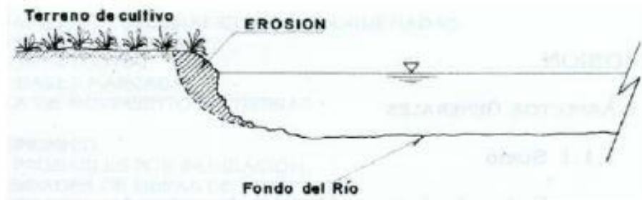
FIGURA N° 1. EROSION FLUVIAL - RIBEREÑA
