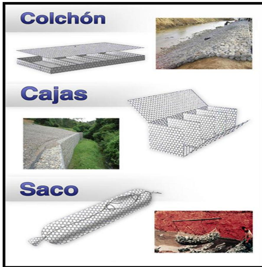
Figura N° 6: Tipos de gaviones Fuente: Mundo de gaviones (21)
