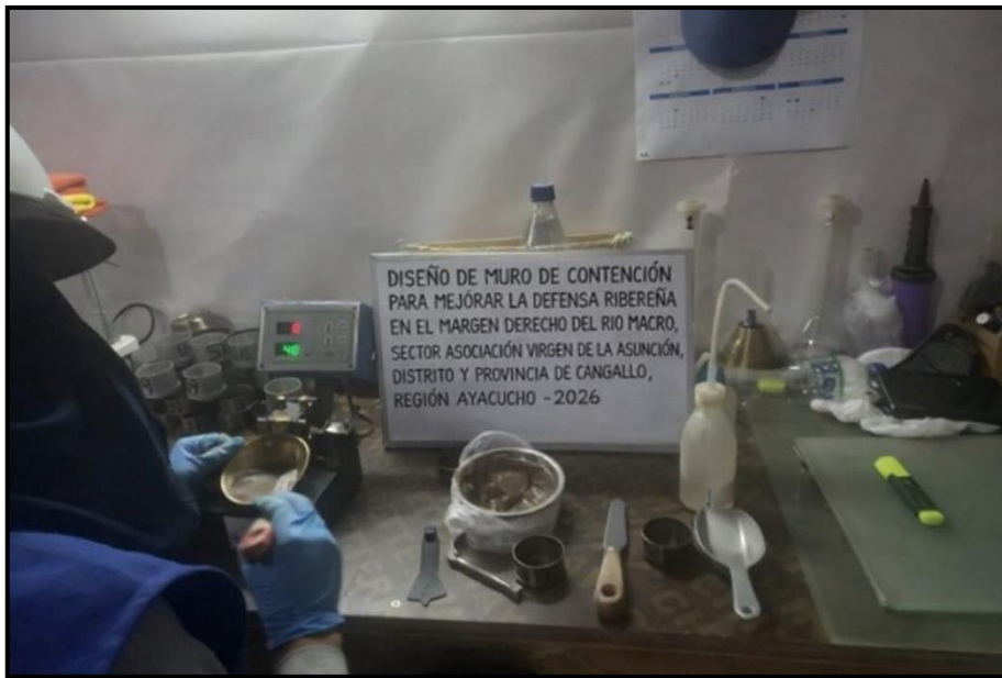
Figura 50: Se observa la realización del ensayo del estudio de suelo con la muestra obtenida. Fuente: Elaboración Propia 2026
