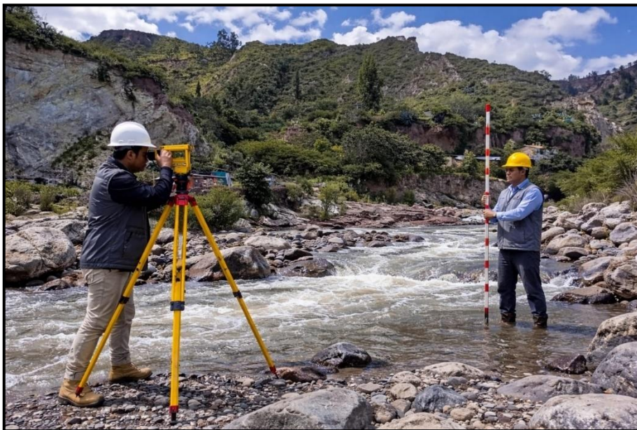
Figura 47: Se observa el levantamiento topográfico para realizar perfil longitudinal del río. Fuente: Elaboración Propia 2026
