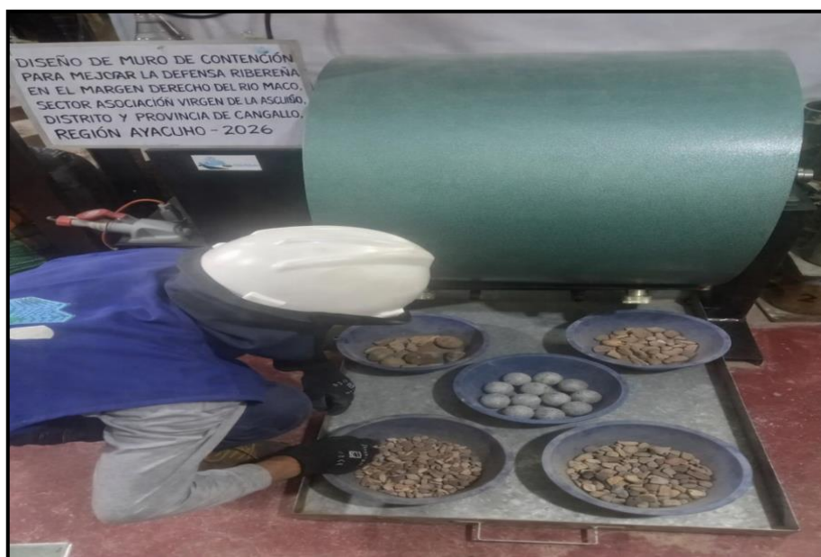
Figura 53: Se observa la realización del ensayo de granulometría del suelo. Fuente: Elaboración Propia 2026
