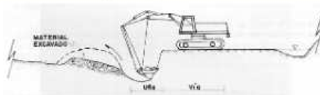
FIGURA N°21. EXCAVACION DE LA UÑA DE ESTABILIDAD
