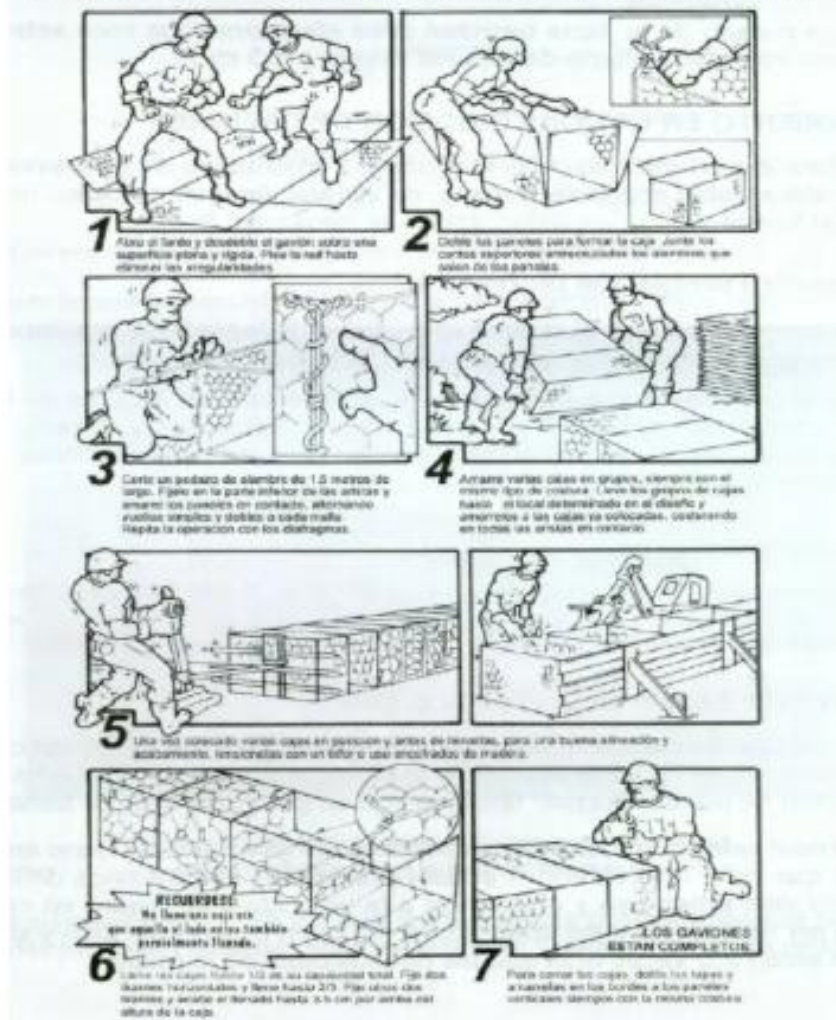
FIGURA N°29. COLOCADO Y LLENADO DE GAVIONES
