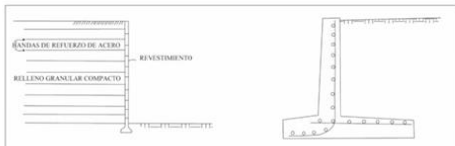
Muros de Tierra Armada
