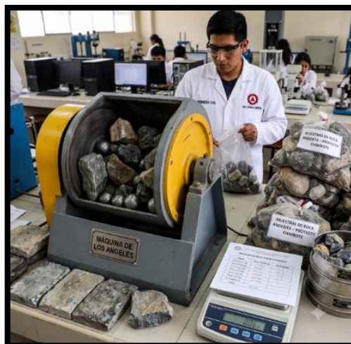
Figura 5. Ensayo de Abrasión para medir la resistencia al desgaste del enrocado.
