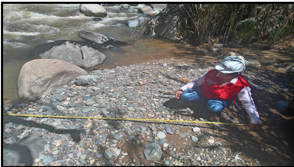
Figura 54: Medición de ancho de cauce y caracterización de depósito granular en el río Quiroz en el tramo 0+400 – 0+450.
