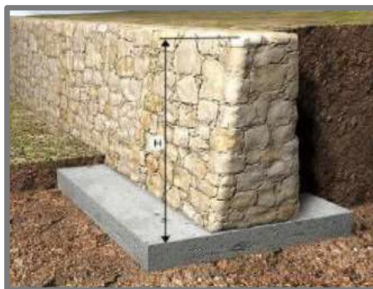
Figura 23: Muros de contención.
