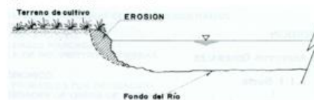
FIGURA N° 1. EROSION FLUVIAL - RIBEREÑA
