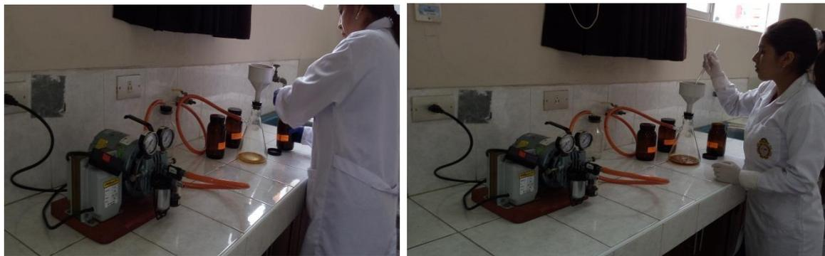
**Figura 5: Técnica al vacío de filtrado de los extractos.**
