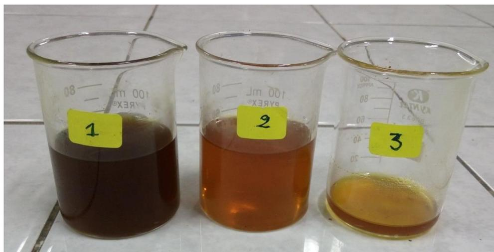
**Figura 6: Extractos etanólicos: Muestra 1: 50g/50ml, muestra 2: 50g/50ml y extracto Hidroalcohólico de propóleo de la serranía: Muestra 3: 20g/25ml.**
