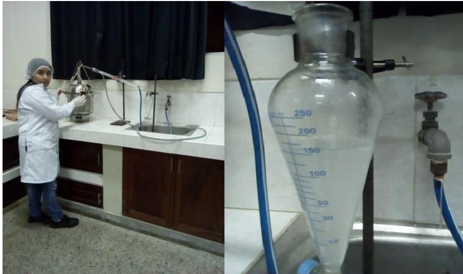
Figura N° 03: Técnica que se utilizó para la extracción del aceite esencial es: Destilación por arrastre de vapor.
