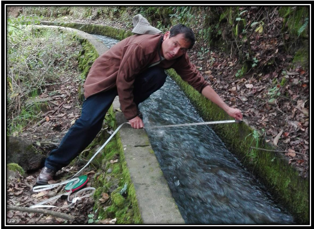
Imagen 27: Realizando mediciones de las secciones del canal.
