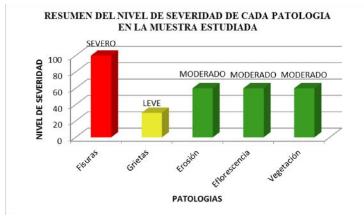
Gráfico 26: Resumen del nivel de severidad de cada patología en la muestra estudiada del canal de regadío Chaquecocha Aguacoto.
