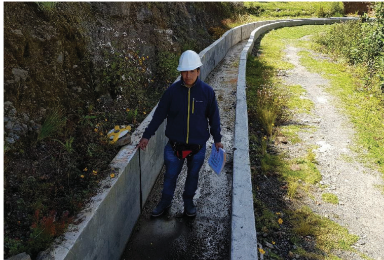
Imagen N° 13: En la vista se observa el inicio de la muestra del canal Juitush haciendo recolección de datos con la ficha de inspección
