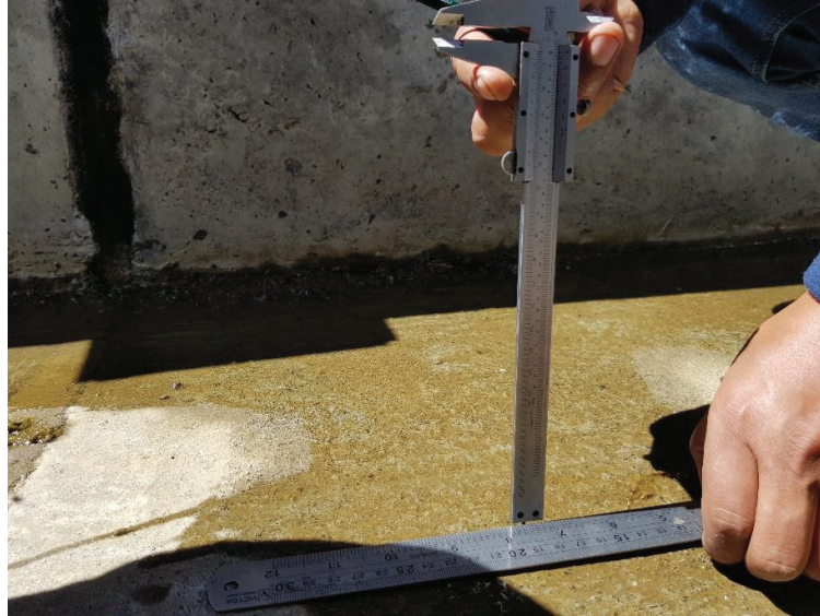
Imagen N° 26: En la vista se observa la medición del espesor erosionada en la progresiva 3+805.00 a 3+819.40 para la unidad muestral N° 08
