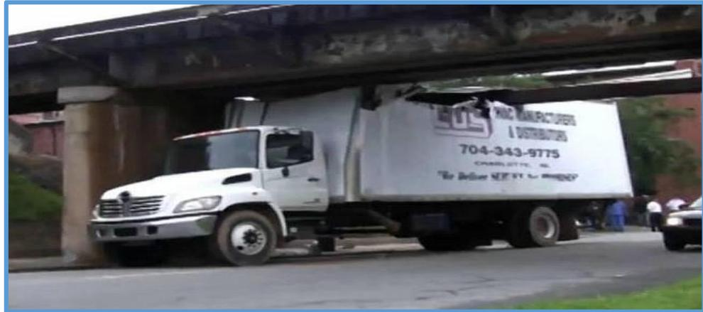
*Figura 37. Fuerza de Impacto en la estructura del puente.*
