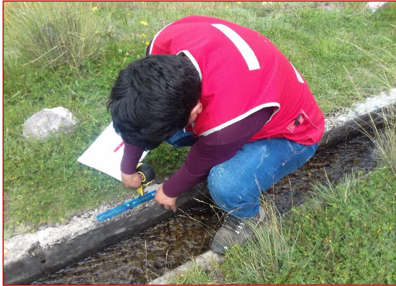
FOTO N° 03: VISTA DE TOMA DE MEDIDAS DE LA PATOLOGIAS DE DESCASCARAMIENTO
