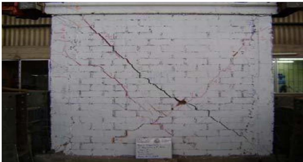
*Figura 22. Grietas en muro confinado*
