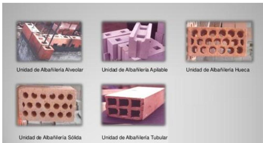
*Figura 16.* Tipos de unidad de albañilería
