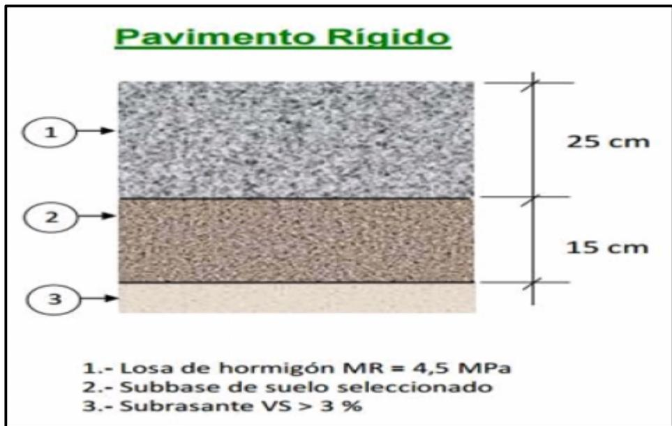
**Gráfico N° 09** : Espesor de losa de un pavimento Rígido
