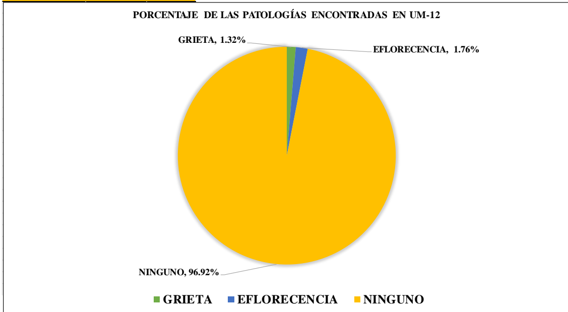
Figura 60. Porcentaje de patologías encontradas en la Unidad Muestral 12. Nota. Fuente: Elaboración Propia. (2018).
