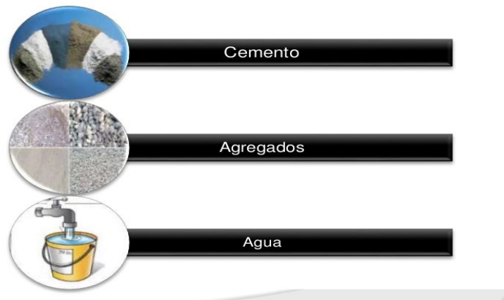
Figura 11. Componentes del Concreto
