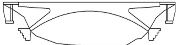
PORTICO CON COLUMNAS INCLINADAS
