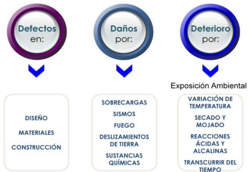
Figura 31: Clasificación general de patologías en las edificaciones.
