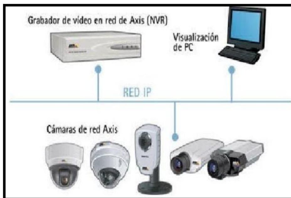
Figura. N° 10 Sistema de vigilancia en red utilizando NVR
