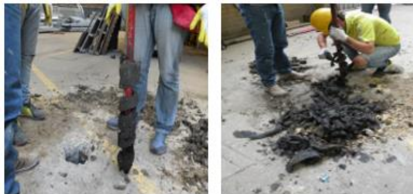
Figura 3: Localización de apiques para la verificación de la cimentación superficial a 1.20 metros de profundidad. Nota: Fuente: Díaz P. (2015).
