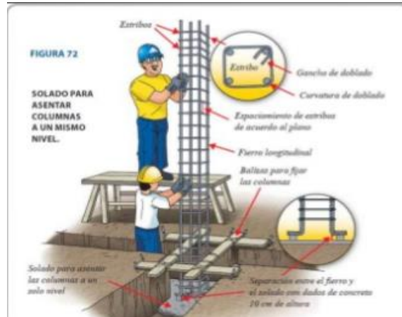
Figura 13: Colocación de las columnas. Nota: Fuente: Huayanca (2015).
