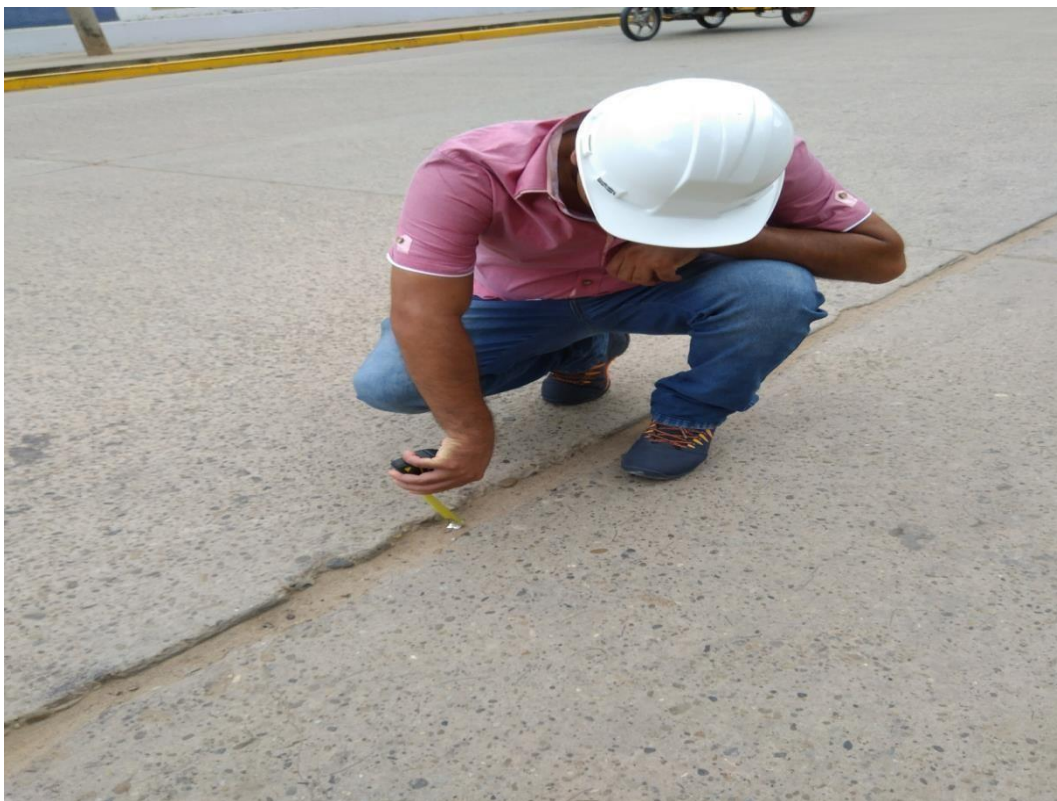
FOTO 1: FALLAS PATOLÓGICAS EN LA PAVIMENTACIÓN EL JIRÓN ALFREDO EGLINTON
