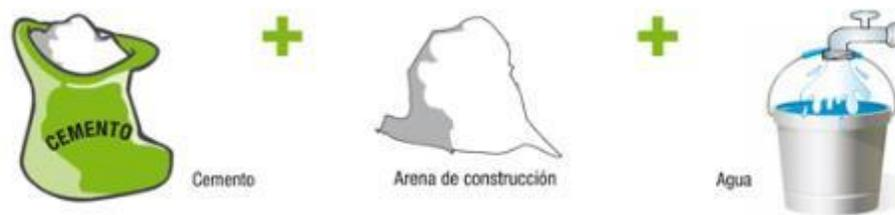
**Figura 01. Elementos del Concreto – Fuente: Joaquin Porrero S.<sup>7</sup>**
